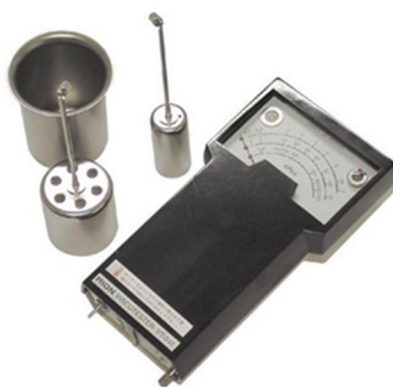
Viscometer Rion VT-03 dan VT-04
